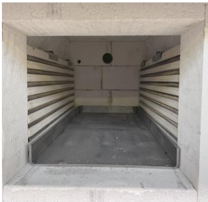
Dettaglio dell'interno della camera con suola in acciaio refrattario per supporto carica
